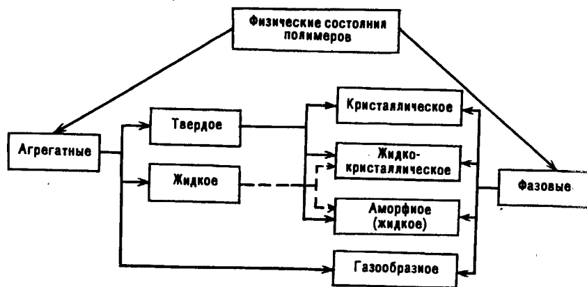
Рис. 3.1. Схема физических состояний и переходов полимеров
